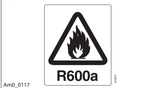
Fig. 6: Sticker op compressor voor R600a
